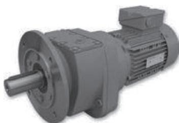
2段及び3段減速構造で豊富な減速比を用意。最大トルク10,000Nm、最小回転数1.2rpm。脚、フランジのコンビネーションにより、前方向取り付けがさらに自由に。長寿命潤滑、低バックラッシュ。
